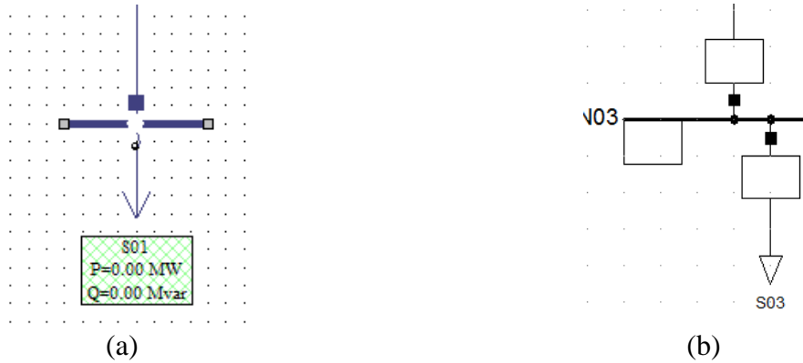
Fig. M.11 – Reprezentarea sarcinilor în programele Neplan (a) și DIGSilent Power Factory
